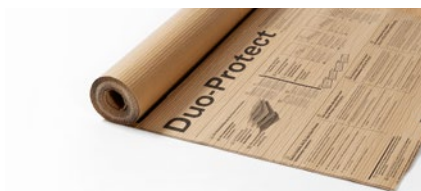
Duo-Protect podłoża mineralne ochrona przed wilgocią i tłumienie odgłosu kroków Odporność na ściskanie do 20 000 kg/m 2 Grubość: 2,5mm
